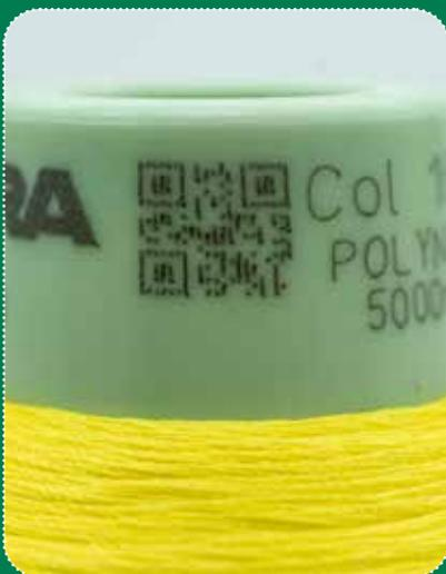
*Eine scannbare Codierung für die automatische Produktion*
